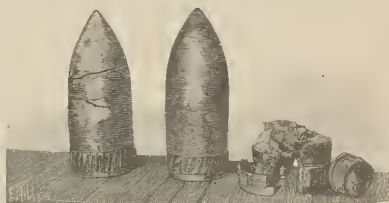
En plancha de acero. - En plancha Compound . - En plancha de acero níquelado. - Estado de los proyectiles después del tiro
